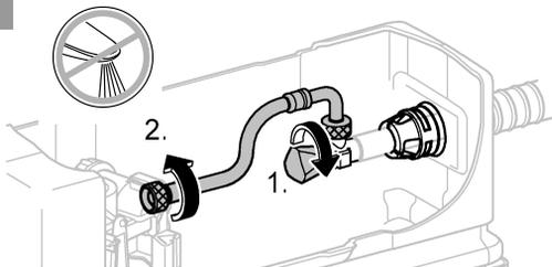
Skyddsör med YD 25mm ska användas tillsammans med medleverad genomföring/tätning. Mediaröret ansluts mot R15 (1/2") utvärdig gänga med koppling enligt mediarörets monteringsanvisning. CE godkända medierör i Ø12/Ø16mm med skyddsör YD 25mm kan användas. Dimension tillkopplings-ventil: R15 (1/2") utvärdig rörgänga. Täthetskontroll av röranslutningarna ska utföras efter installationen.
