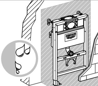
Skruvinfästningar i väzton 1 ska göras i betong eller annan massiv konstruktion, träreglar, träkortlingar eller i konstruktion som är provad och godkänd för infästning, till exempel skivkonstruktion. Se exempel på godkända konstruktioner på säkervatten.se. Skruvfästningar i väzton 1 får inte göras enbart i golv- eller väggskiva.
