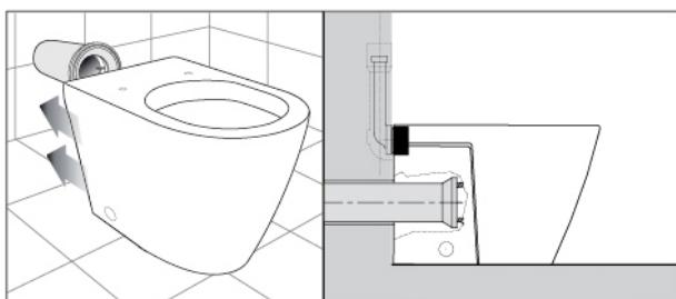
Helyezze a WC csészét a helyére. Gondoskodjon arról, hogy szorosan zárjon a bemeneti és kimeneti cső egymással, és ne akadályozza a padló rögzítő tartói. Végezzen próba öblítést, ellenőrizze, hogy ne szivárogjon.
