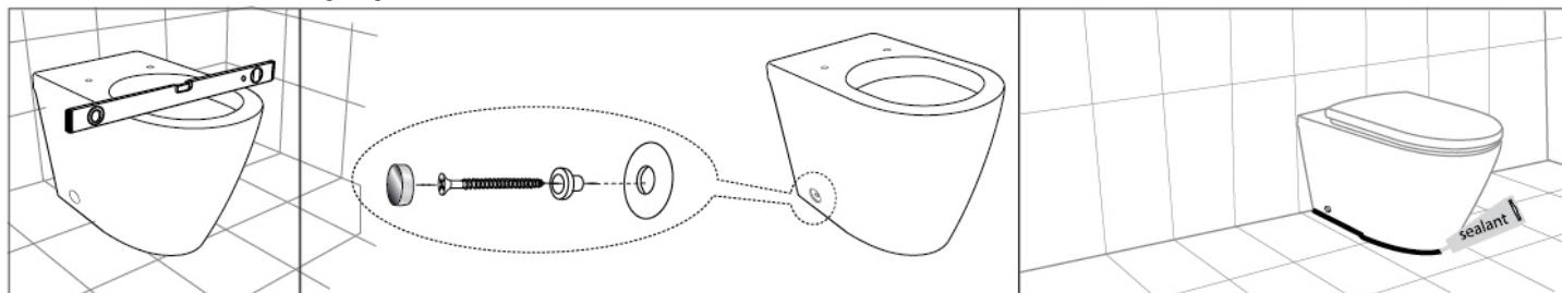
Asigurați-vă că vasul WC este orizontal. Fixați vasul WC pe podea cu ajutorul șuruburilor de fixare și a materialelor de etanșare flexibile. Montați capacul WC Soft Close.
