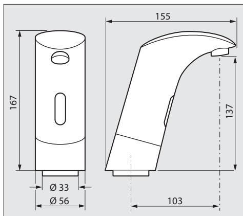
**D** Fließdruck (min - max): 0,5 - 5,0 bar
