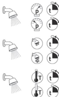
E' possibile impostare il tempo d'erogazione mediante l'ago di regolazione ad una pressione di 3 bar tra i 10 e i 30 secondi. E' normale che si verifichino variazioni del tempo d'erogazione dovute ad oscillazioni di pressione sulla rete di alimentazione.
